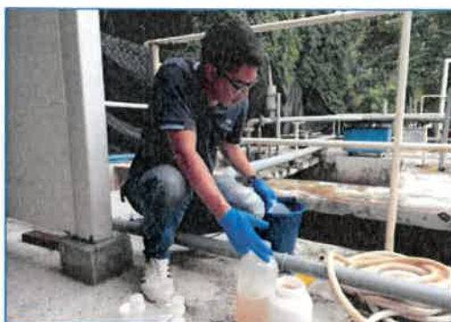
ภาพถ่ายที่ 3.4.5-1 การตรวจวัดคุณภาพน้ำทิ้งจากบ่อพักน้ำทิ้ง
